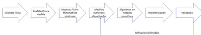
Figura 2. Esquema de trabajo para realizar simulaciones CFD
